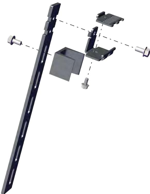
Fig. 4: Assemblage de l'unité de l'entraînement les vantaux du TSG
