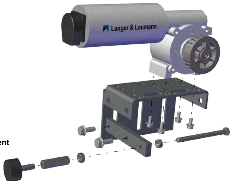
Fig. 3: Assemblage de l'unité de l'entraînement du TSG
