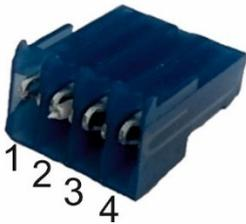
**Fig. 5: Connecteur CAN 4 pôles XF5**
