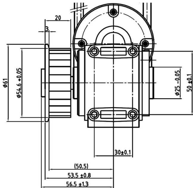
Abb. 2: TSG Antrieb: Sicht stirnseitig auf Getriebe
