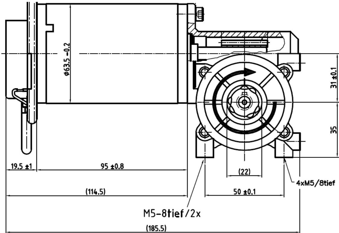
Abb. 1: TSG Antrieb: Sicht seitlich gesamt
