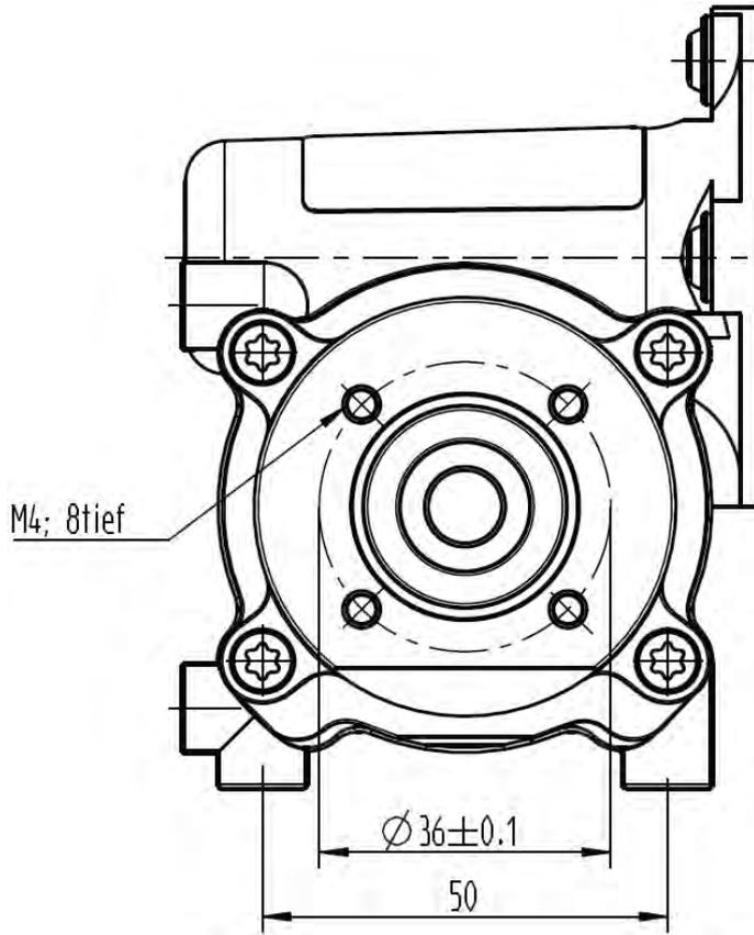
Abb. 3: TSG Antrieb: Sicht seitlich
