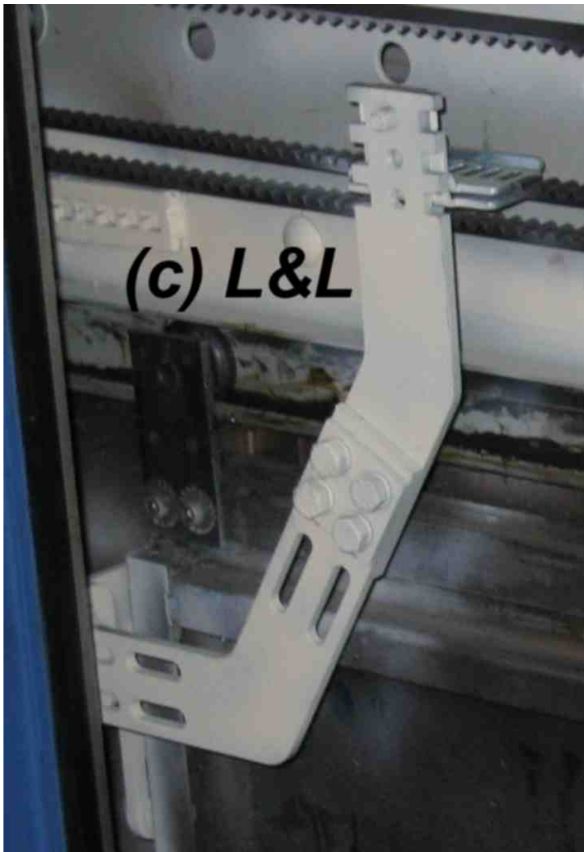
Abbildung 17: Mitnehmer langsamer Türflügel (hier: teleskopierend links)
