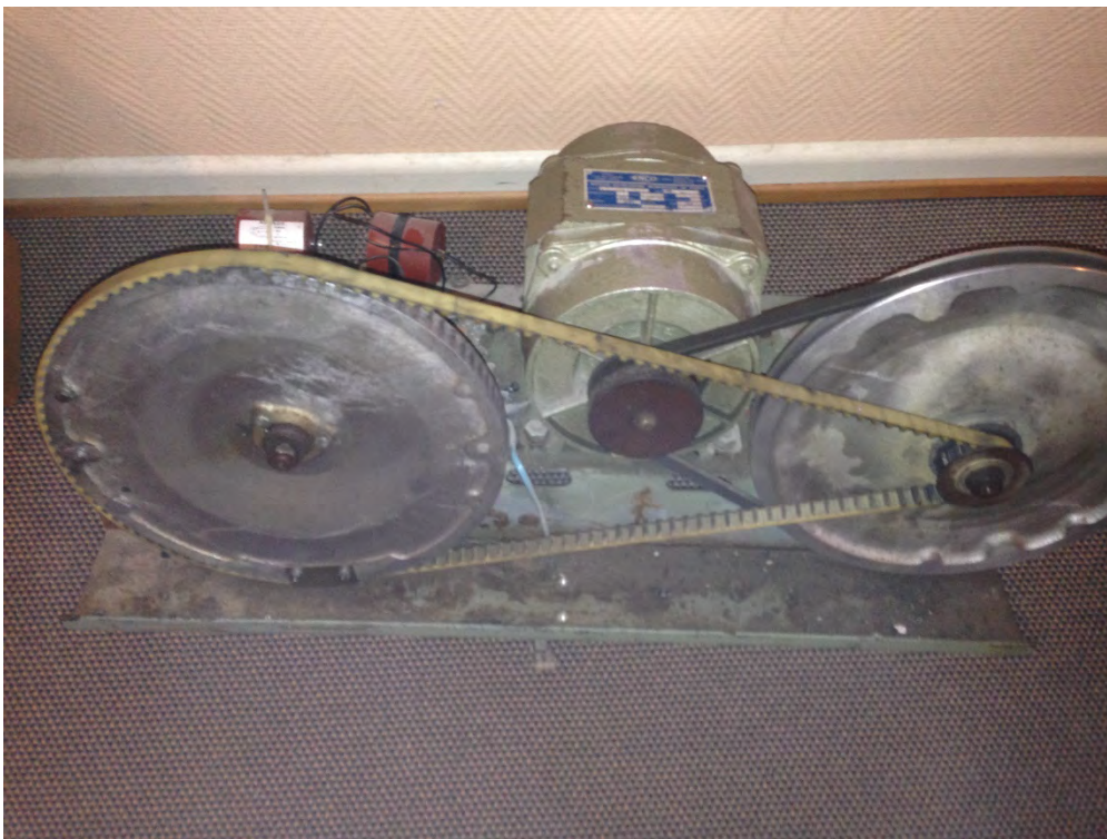
Abb. 2: Soretex Antrieb, demontiert
