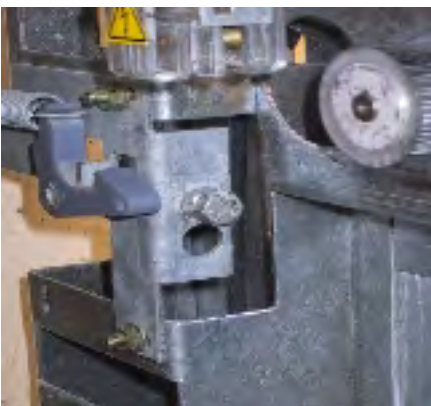
Abb. 3: Anschlag durch eine 8mm Schraube
