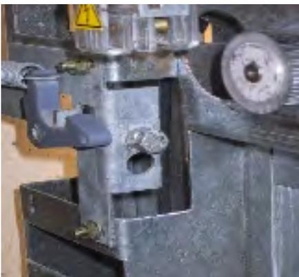
**Abb. 3: Anschlag durch eine 8mm Schraube**
