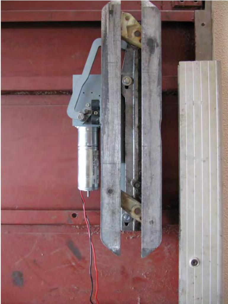
Abb. 14: Ansicht Montage Schwertantrieb bei TL
