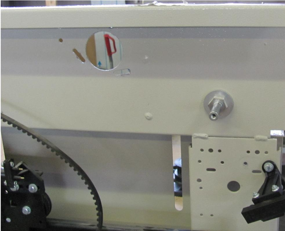
**Fig. 12: Entraînement démonté et grand poulie**
