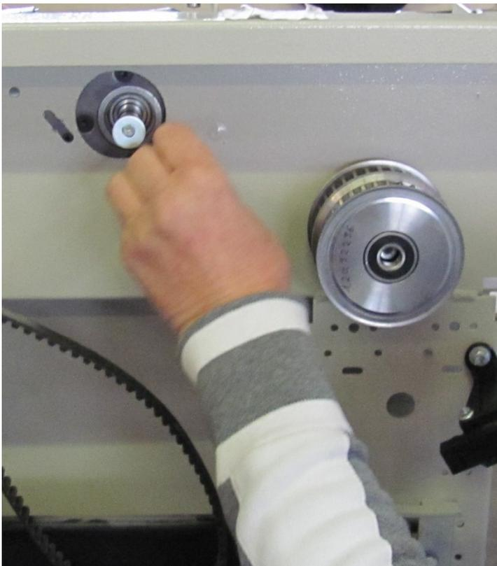
**Fig. 13: Nouveau double poulie monté et TSG entraînement (encore sans poulie)**
