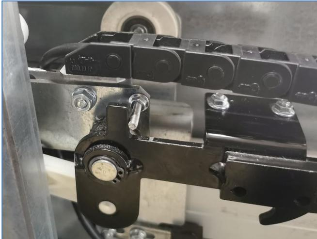
**Abb. 13: Befestigung Energiekette**
