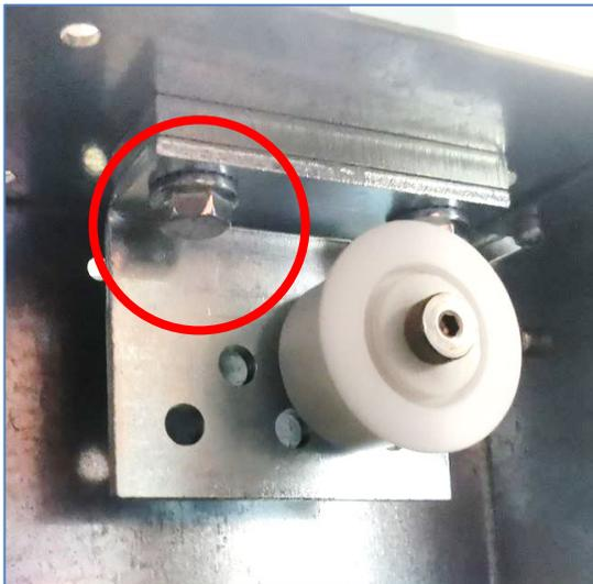
**Abb. 8: ggfs. Tausch der Schraube durch Senkschraube**
