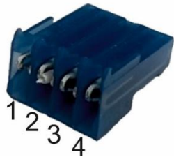
Abb. 5: 4-poliger CAN Anschluss XF5
