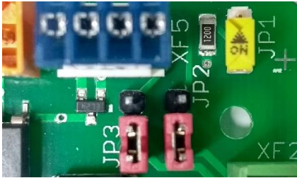
Fig. 7: Réglage standard, alimentation 24V par XF2
