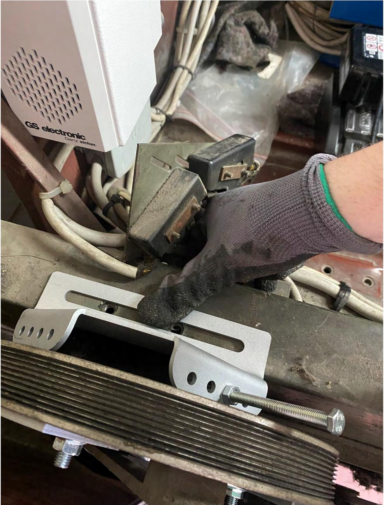
Abb. 4: Montage des Endanschlag
