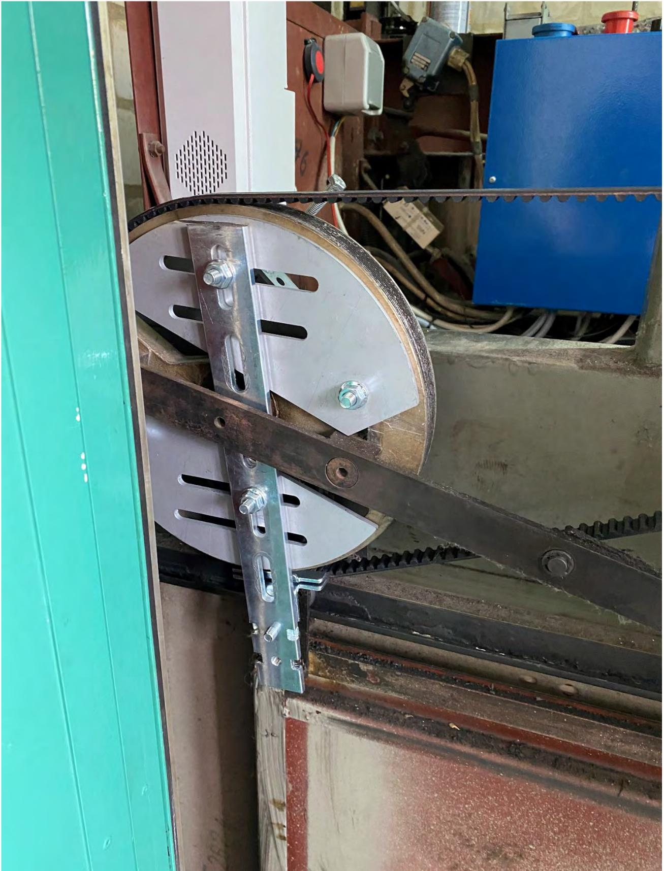
**Abb. 6: Montage des Türflügelmitnehmers (ggf. kürzen)**
