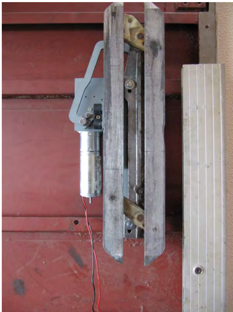
Img. 14: Vu montage came/sabre pour l'ouverture gauche
