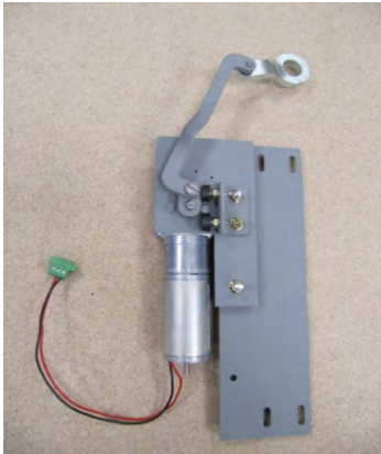
Img. 15: Etat de livraison d'entraînement came/sabre ouverture gauche
