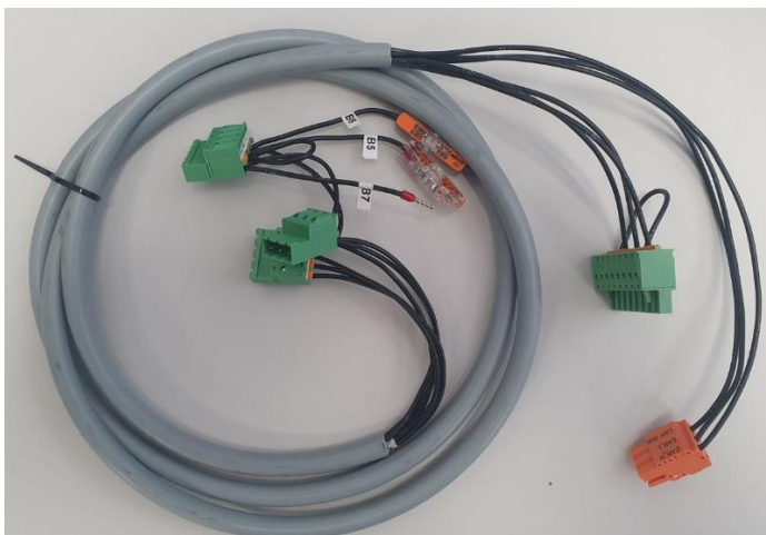
Fig.4 Cable de señal de control
