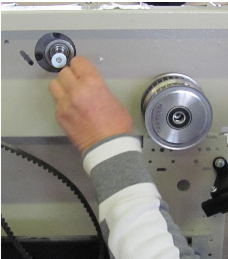
**Abb. 13: Montierte neue Doppelzahnriemenscheibe und TSG Antrieb (noch ohne Ritzel)**
