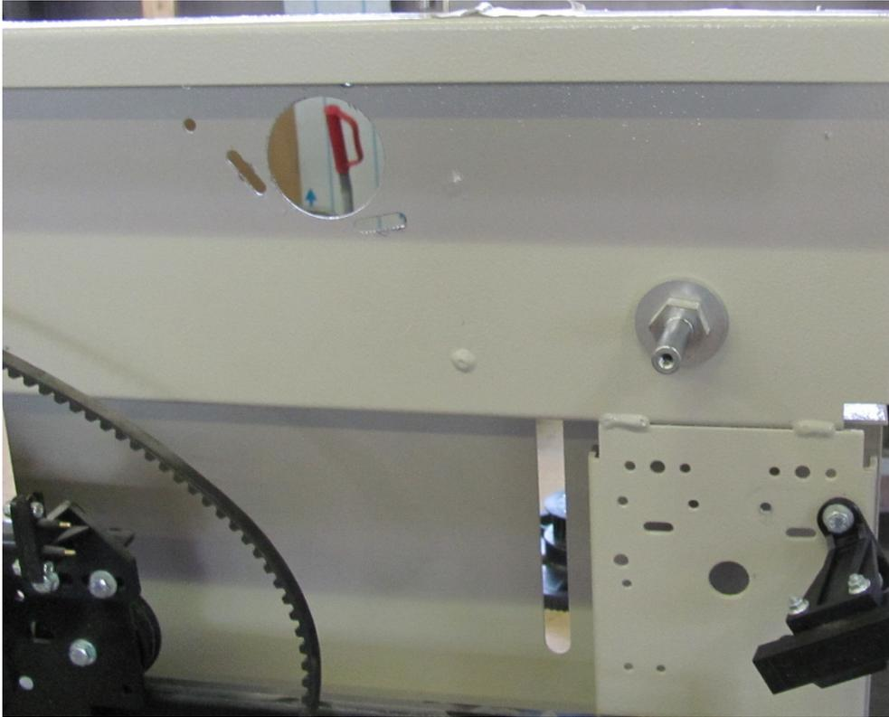
**Abb. 12: Demontierter Antrieb und große Zahnscheibe**
