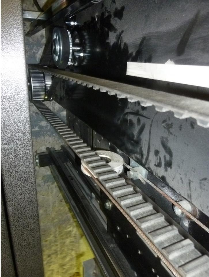
**Abb. 18: fertig montierte Türmaschine mit TSG (zentral öffnend)**
