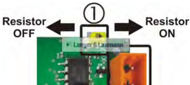
Abb. 3: TSG CANopen Lift Modul - Buserminierung
