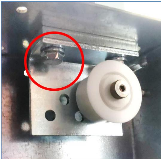
**Fig. 8: Remplacer la vis par une vis à tête fraisée, si nécessaire.**
