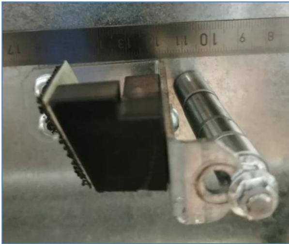
**Fig. 1: Butée pour l'agrafe de la courroie crantée**
