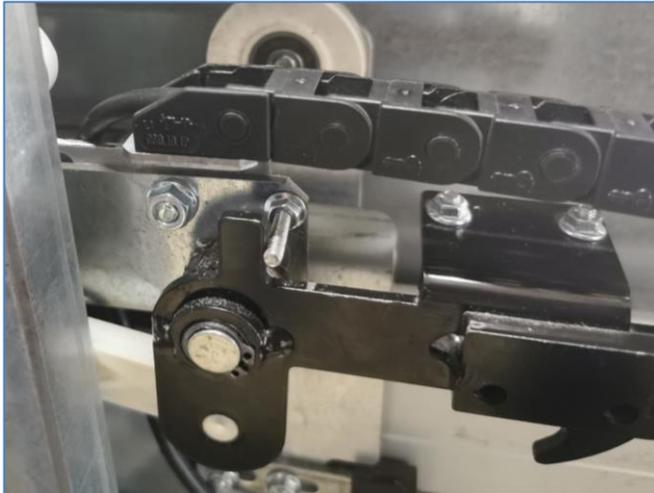
**Fig. 13: Fixation de la chaîne d'énergie**
